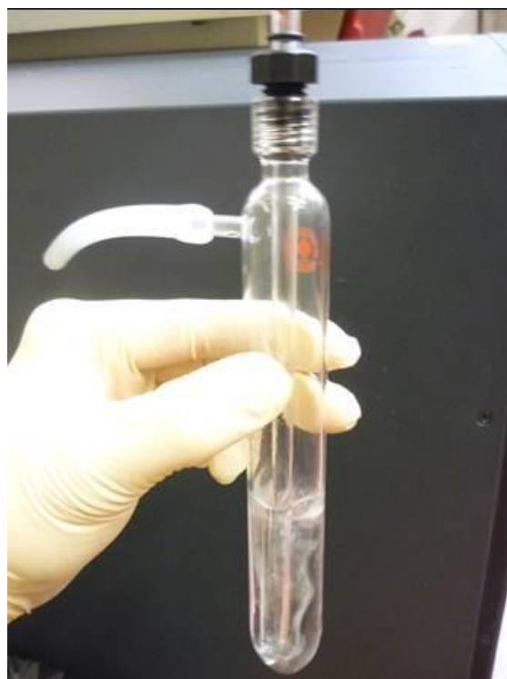
Fig. 1. Gorgogliatore con soluzione acida utilizzata per l'intrappolamento degli elementi chimici in esame.
