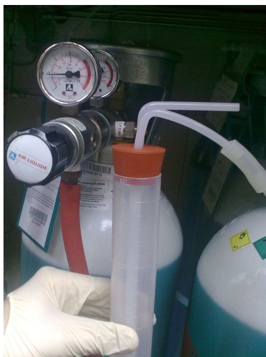
Fig. 1. Trasferimento del gas in trappola acida da bombola tramite regolatore di pressione a doppio stadio.
