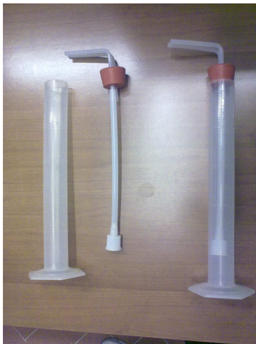
Fig. 2. Gorgogliatore per cattura contaminanti metallici e metalloidi in trappola acida.
