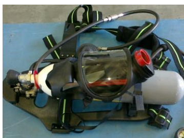
Carenza di componenti dell'autorespiratore e/o nella conservazione del dispositivo.
