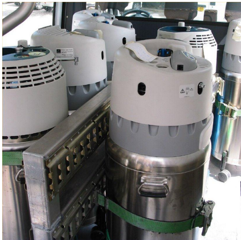
Fig 4 Esempio di separazione di contenitori LOX pieni e vuoti.
