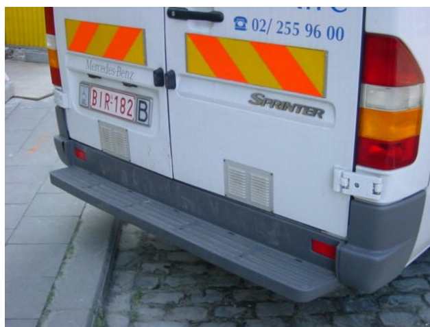
Fig 1 Esempio di griglia di ventilazione sul fondo del portellone posteriore del veicolo adibito alle consegne.
