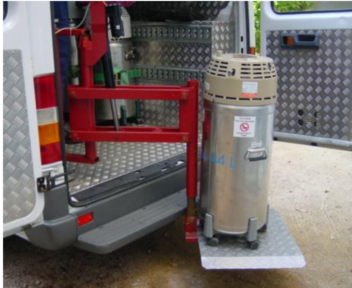
Fig 7 Esempio di montacarichi utilizzato per caricare e scaricare dal veicolo bombole piene e vuote.
