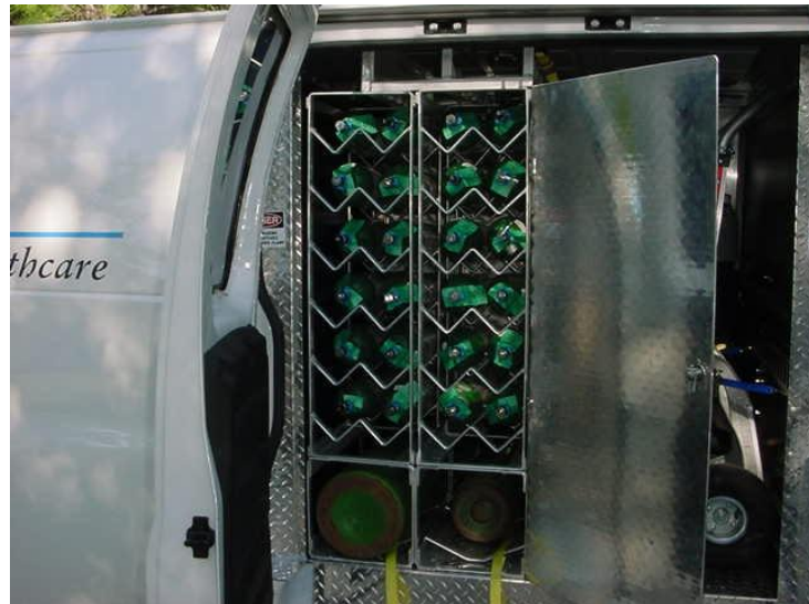
Fig 2 Esempio di rastrelliera per bombole su veicolo adibito alle consegne
