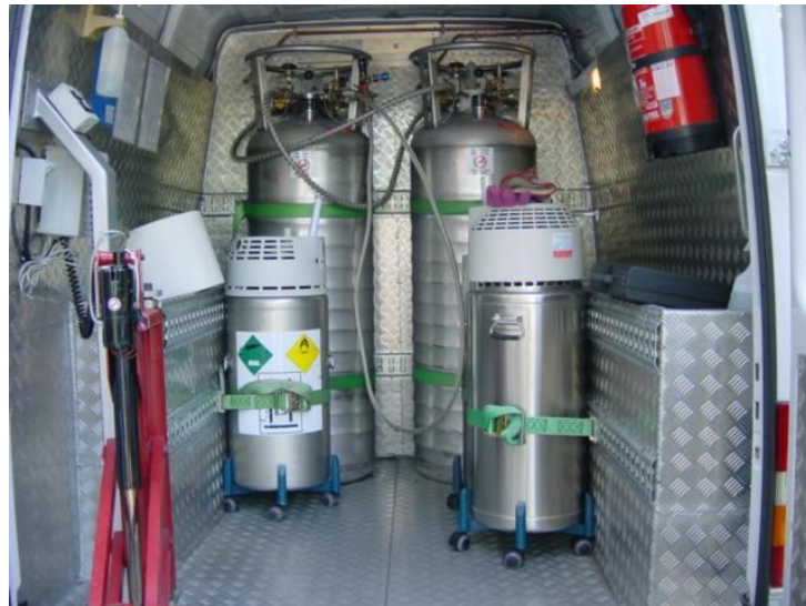
Fig 3 Esempi di posizionamento e fissaggio di contenitori criogenici su veicolo adibito alle consegne.
